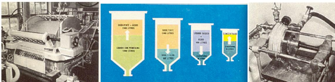
*Figuras 20,21 y 22. Izquierda, filtro rotatorio con vacío, centro, sistema de extracción, derecha, filtro*
