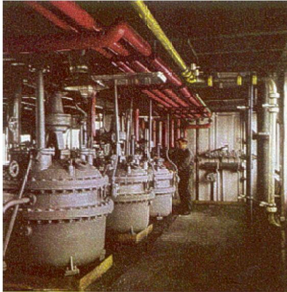
*Figura 40. No se utiliza sólo un reactor para la fabricación del DDT sino toda una serie. En éstos se realiza la condensación del clorobenceno con el cloral, con la ayuda del ácido sulfúrico.*
